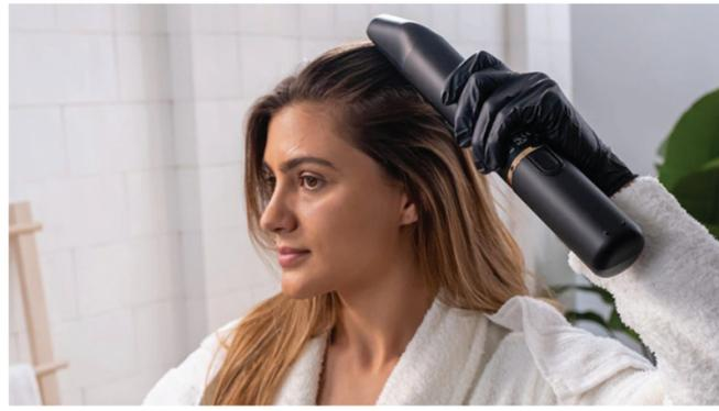
**Colorsonic.** L'Oréal reinventando la coloración del cabello en el CES 2022. Un mezclador personalizado y un dispositivo que dispensa la dosis correcta de tinte y la aplica a través de una boquilla oscilante de cerdas a medida que se mueven en un patrón en zigzag para distribuir uniformemente sobre el cabello.
