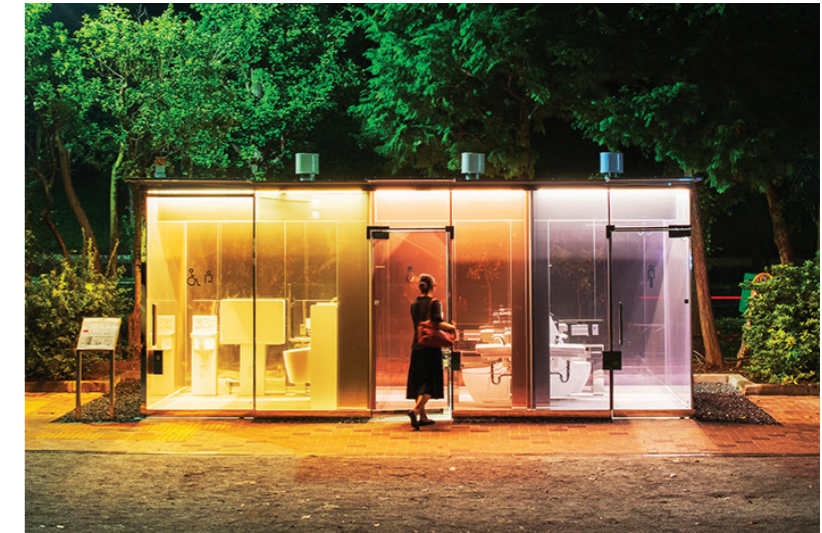
El vidrio permanece transparente cuando el baño está vacío y se vuelve opaco cuando se cierra para su uso.
